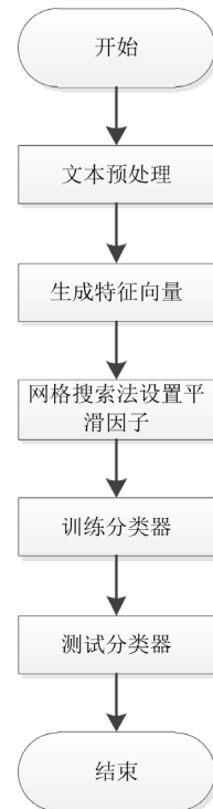
图1 分类器设计流程
